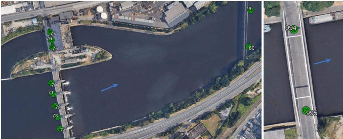
Figure 19: Vue de l'ensemble du réseau d'hydrophones (en vert) implanté sur le site d'Ampsin-Neuville. Le sens du courant est représenté par la flèche bleue.
