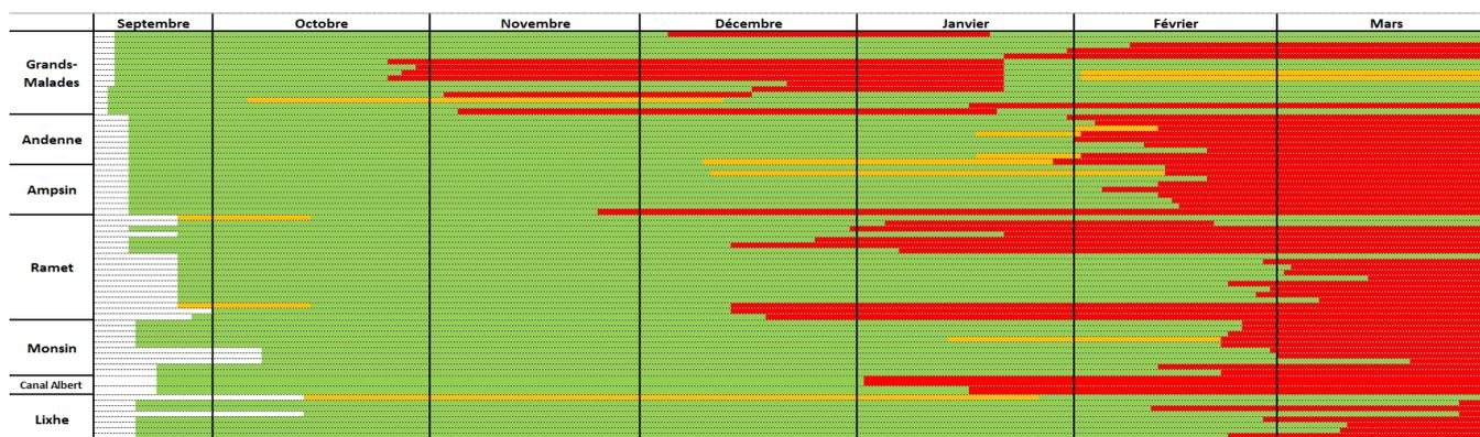
Figure 25 : Périodes de fonctionnement des hydrophones du réseau au cours de l'étude sur les différents des sites. En Vert les périodes où les données ont été enregistrées, en Orange les périodes de dysfonctionnement non liées aux batteries (pannes, disparition des hydrophones...), en Rouge les périodes d'arrêts dû aux batteries.
