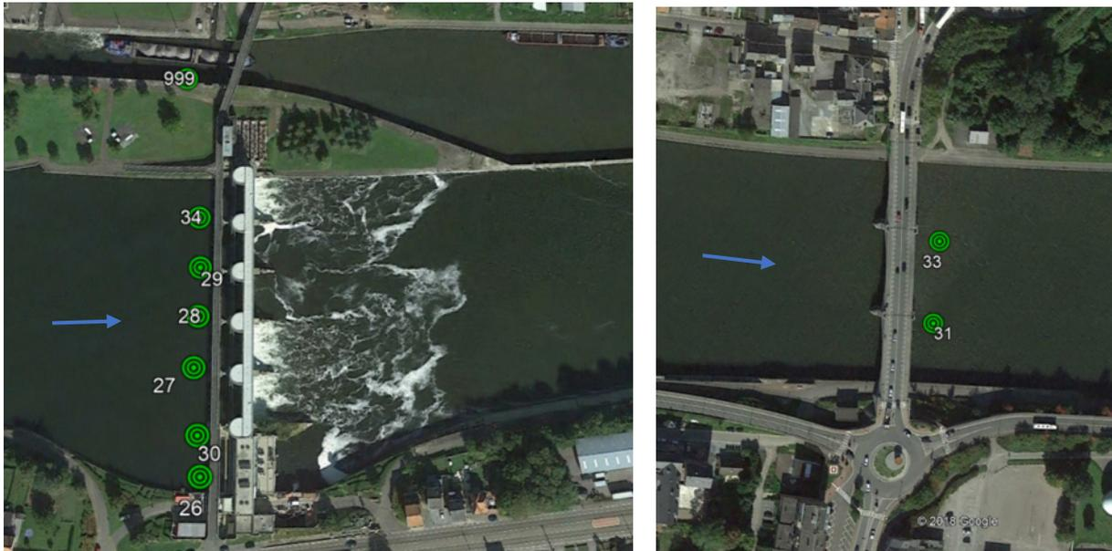
Figure 16 : Vue de l'ensemble du réseau d'hydrophones (en vert) implanté sur le site d'Andenne. Le sens du courant est représenté par la flèche bleue.
