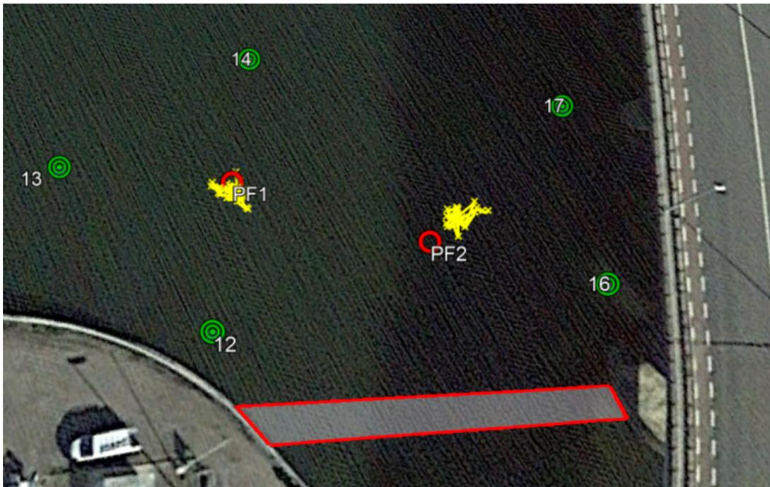
Figure 12 : Calcul des positions d'émetteurs immobiles dans le réseau d'hydrophones par le logiciel U-MAP
