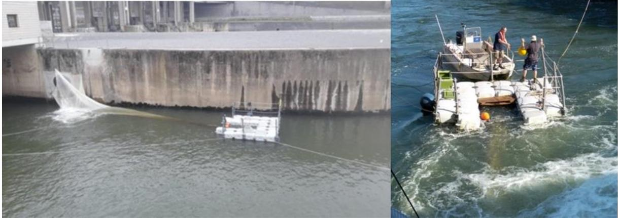
Figure 7 : vue du dispositif de capture des smolts constitué du filet accroché à la paroi autour de la sortie de l'exutoire et relié à une cage suspendue par un ponton flottant, accessible depuis l'aval par bateau.
