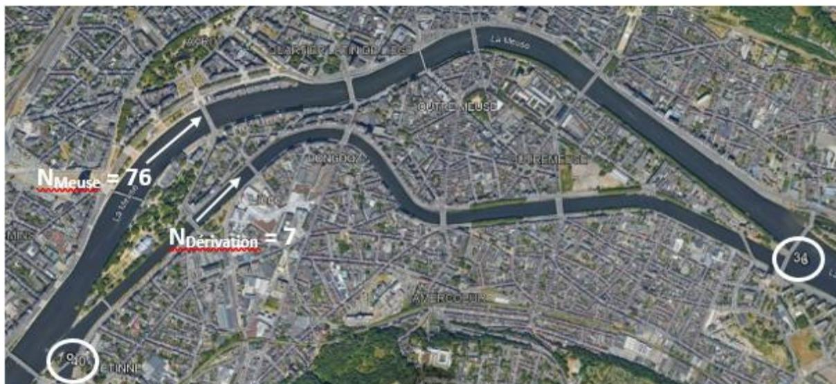
Figure 24 : Vue aérienne de la répartition des voies de passage des smolts entre la dérivation et la Meuse. Les points blancs numérotés 34 et 40 représente la position des hydrophones du réseau.
